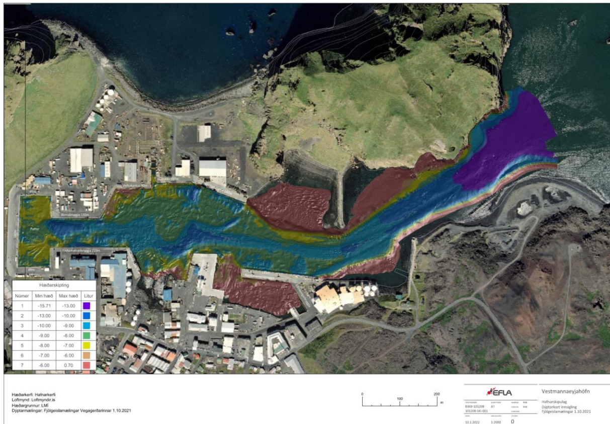
MYND 1 Dýptarkort fyrir innsiglinguna inn í Vestmannaeyjahöfn – dýpi uppgefið í metrum og í hæðarkerfi hafnarinnar (Heimild: Dýptarmæling 1.10.2021, Vegagerðin).
