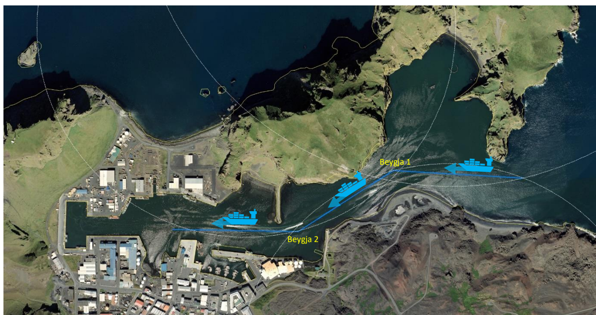
MYND 4 Beygjur í núverandi innsiglingu Vestmannaeyjahafnar. Fyrsta beygja er við Skansfjöru og önnur er fyrir Hörgaeyragarð. Viðmiðunarstærð skips fyrir beygjuradíus er Lagarfoss.
